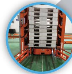
Spolupráce s paletovým zakladačem
