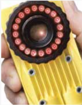
LED zapojené do série poskytují úsporné jasné světlo pro četné aplikace.
